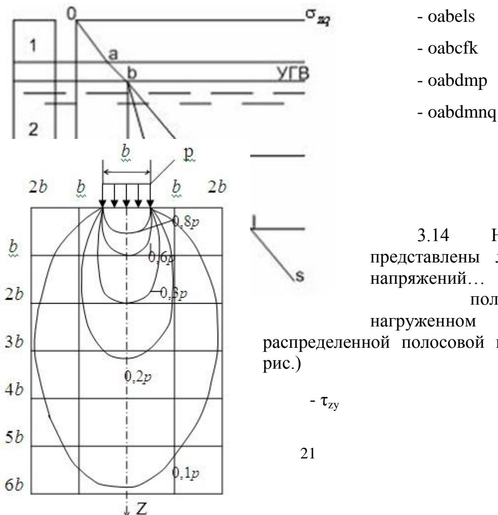
3.14 На рисунке представлены линии равных напряжений... в полупространстве, нагруженном равномерно распределенной полосовой нагрузкой (см. рис.)
