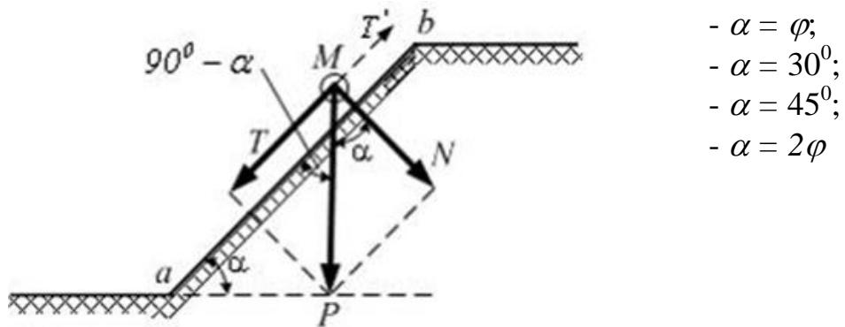
4.6 Уравнение равновесия идеально сыпучего грунта ( $c = 0, \varphi \neq 0$ ) (см. рис.) имеет вид  $T - Nf = 0$ , где  $T$  - ...
