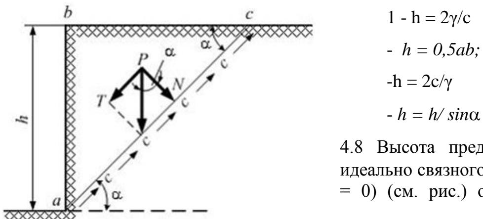
4.8 Высота предельного откоса идеально связного грунта ( $c \neq 0, \varphi = 0$ ) (см. рис.) определяется по
