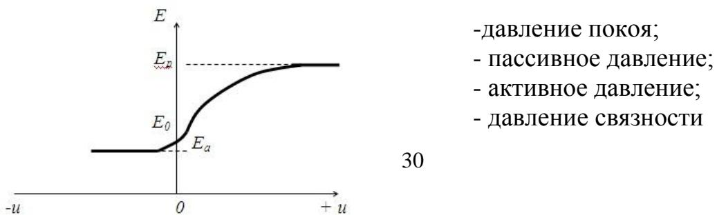
4.20 Активное давление идеально сыпучего грунта на вертикальную гладкую подпорную стенку определяется по формуле  $\sigma_a = \gamma z \lambda_a$ , где  $\lambda_a$  равно...
