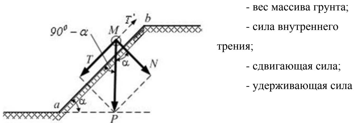
4.7 Из условия равновесия идеально связного грунта ( $c \neq 0, \varphi = 0$ ) (см. рис.)
