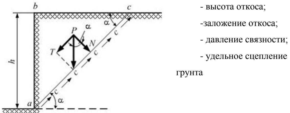
4.9 Коэффициент устойчивости откоса  $\gamma_{st}$  в предположении линейной поверхности скольжения равен... (где  $\Sigma T_{уд}$  - сумма удерживающих сил;  $\Sigma T_{сдв}$  - сумма сдвигающих сил;  $\Sigma M_{уд}$  - сумма моментов удерживающих сил;  $\Sigma M_{сдв}$  - сумма моментов сдвигающих сил;  $F$  - горизонтальная сила;  $N$  - вертикальная сила)
