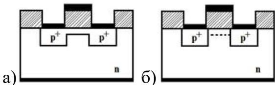
**Правильный ответ:** а – со встроенным каналом, б – с индуцированным каналом
