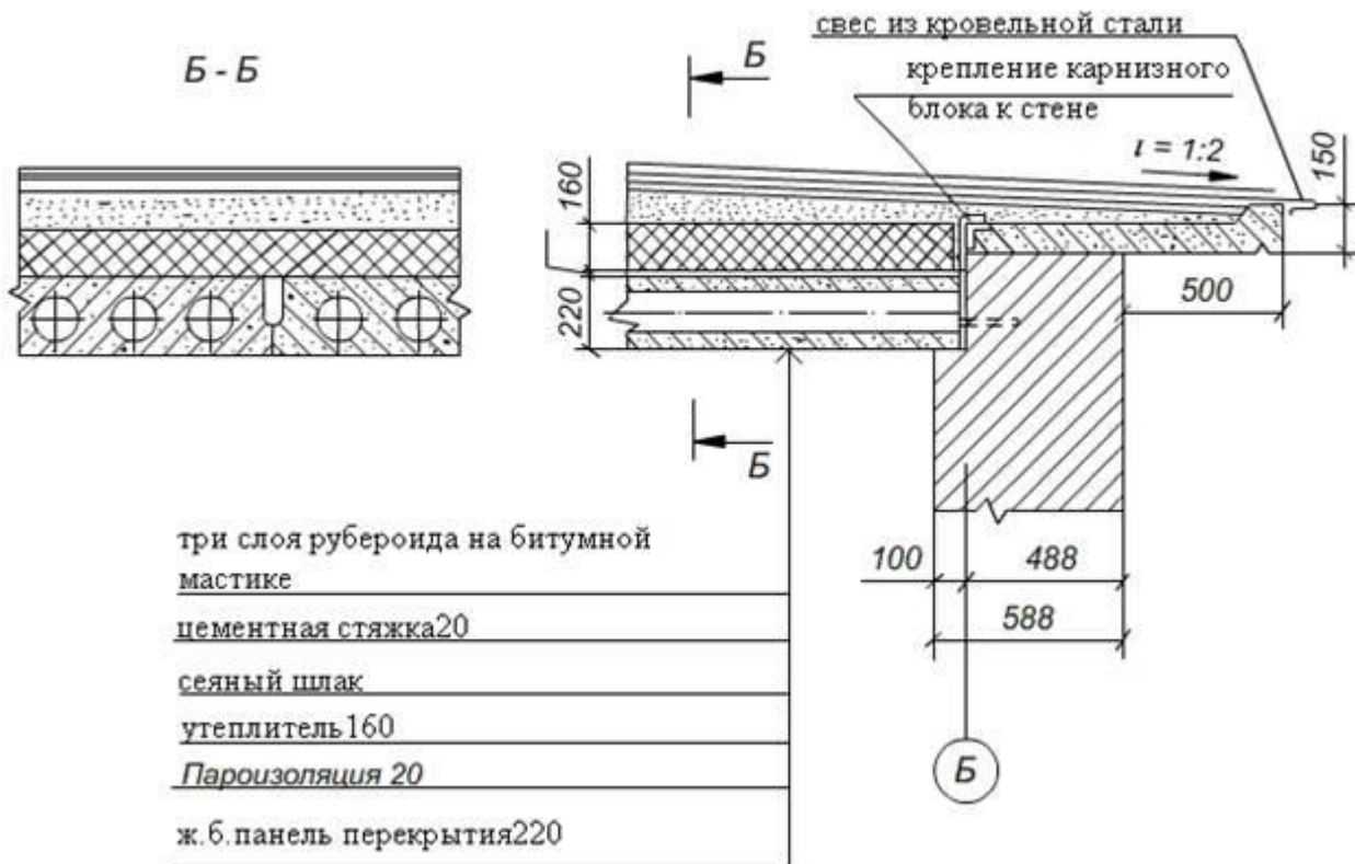
примыкание кровли к стене здания
