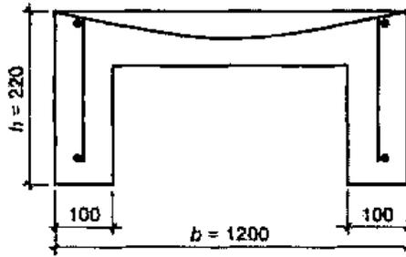
Рисунок 1 – Сечение плиты
