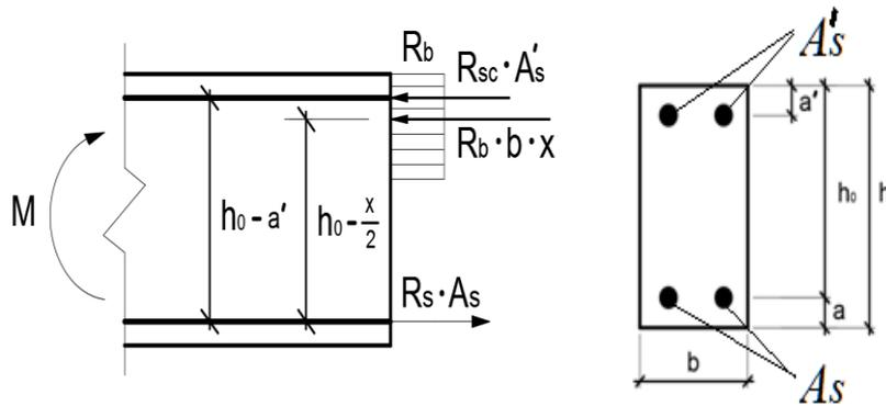
Рисунок 2 – Схема усилий в изгибаемом элементе прямоугольного сечения с двойной рабочей арматурой
