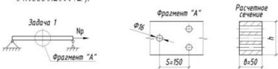
**Задание 2** Подобрать сечение деревянного элемента из цельной древесины, работающего на центральное растяжение при следующих условиях: растягивающее усилие  $N_p=58$  кН; в элементе имеются ослабления тремя отверстиями для болтов  $d_{отв}=20$  мм; расстояние между отверстиями вдоль волокон  $S=140$  мм; класс ответственности здания – III,  $\gamma_n=0.9$ ; температурно-влажностные условия эксплуатации 2 (табл. 1 СП 64.13330.2011 /2/).
