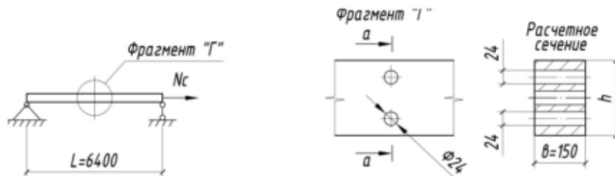
Задание 6 Подобрать сечение цельнодеревянной балки междуэтажного перекрытия при следующих условиях: расчетный пролет балки  $L=4.5$  м; нормативная погонная нагрузка на балку  $q_H = 2,8$  кН/м; расчетная погонная нагрузка на балку  $q_R = 3,4$  кН/м; класс ответственности здания – II,  $\gamma_n=0.95$ ; температурно-влажностные условия эксплуатации 1 (табл. 1 СП 64.13330.2011 /2/).
