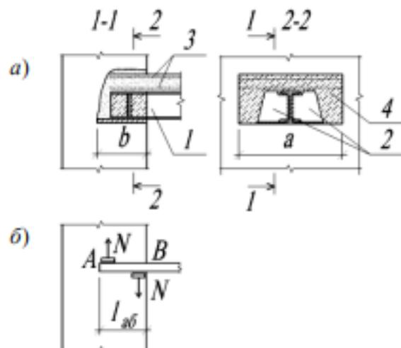
1 – усиливаемая балка; 2 – опорный столик; 3 – опорная сетка и сетка монолитной плиты перекрытия; 4 – бетон омоноличивания балки
