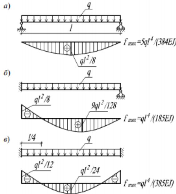
Рисунок - Расчётные схемы и эпюры изгибающих моментов при свободном опирании балок (-, защемлении одной опоры балки (б) и при защемлении двух опор балки (в))
