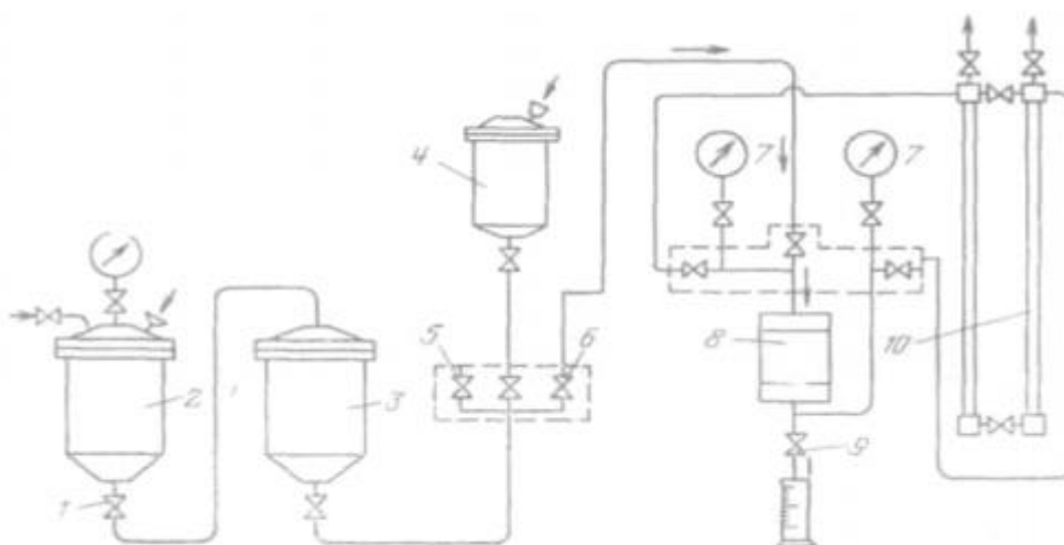
Рисунок 3 – Схема прибора для определения водопроницаемости горных пород
