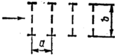
Рисунок 21- Схема расположения ферм или сплошных балок к определению аэродинамического коэффициента
