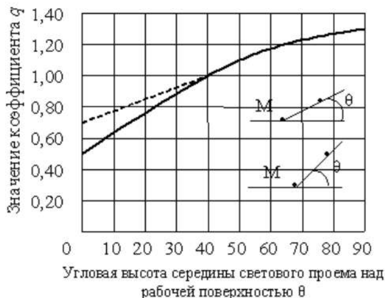
Рисунок 69 - Определение коэффициента неравномерной яркости облачного неба
