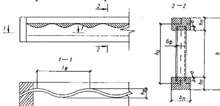
Рисунок 10 – Балка с волнистой стенкой
