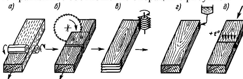
а) а – калибровка; б – вырезка пороков; в – зарезка зубчатых шипов; г – нанесение клея; д – запрессовка и прогрев
