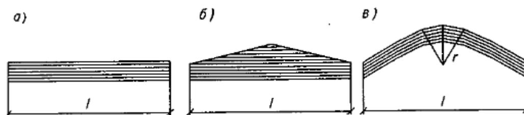
Рисунок 7 – Клеодошчатые балки
