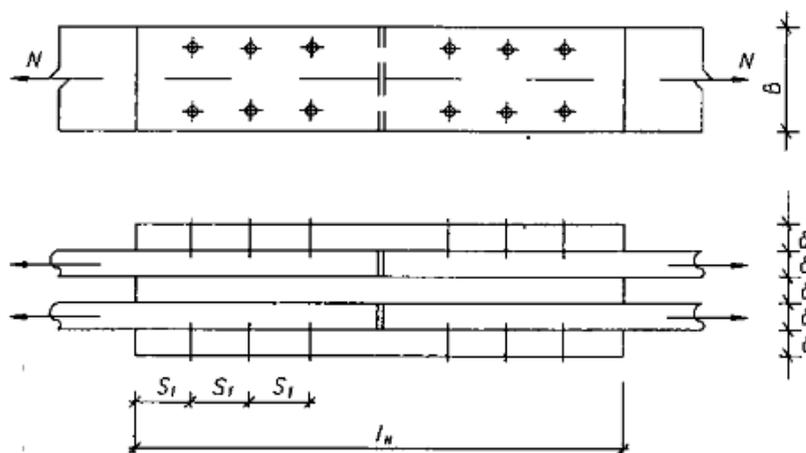
Рисунок 6 – Схема стыка
