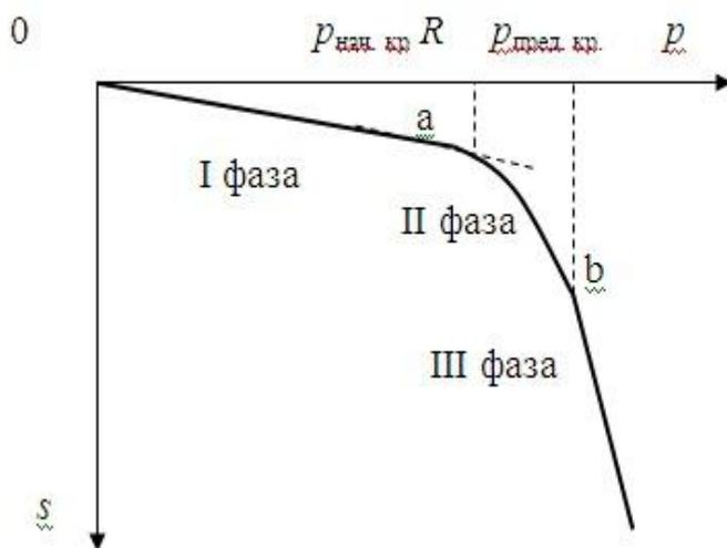
3.19 На графике зависимости осадки штампа от нагрузки (см. рис.) участок  $oa$  соответствует фазе...
