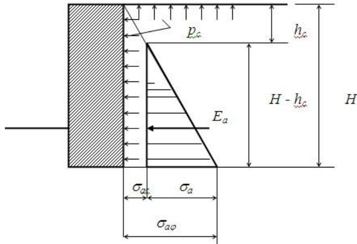
4.25 Равнодействующая активного давления связного грунта на вертикальную гладкую подпорную стенку (см. рис.) определяется по формуле...
