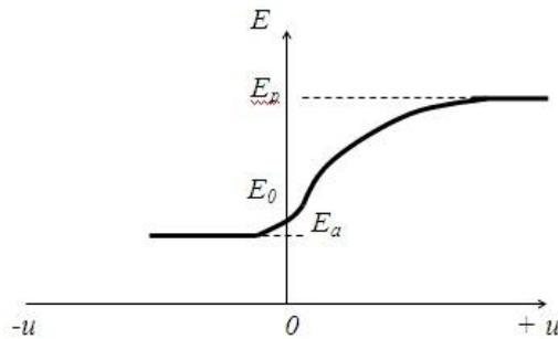
4.18 Давление, возникающее в грунте засыпки при смещении подпорной стенки в сторону грунта (см. рис.), называется ...
