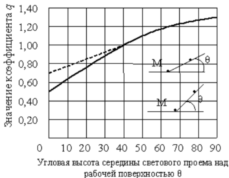
Рисунок 69 - Определение коэффициента неравномерной яркости облачного неба
