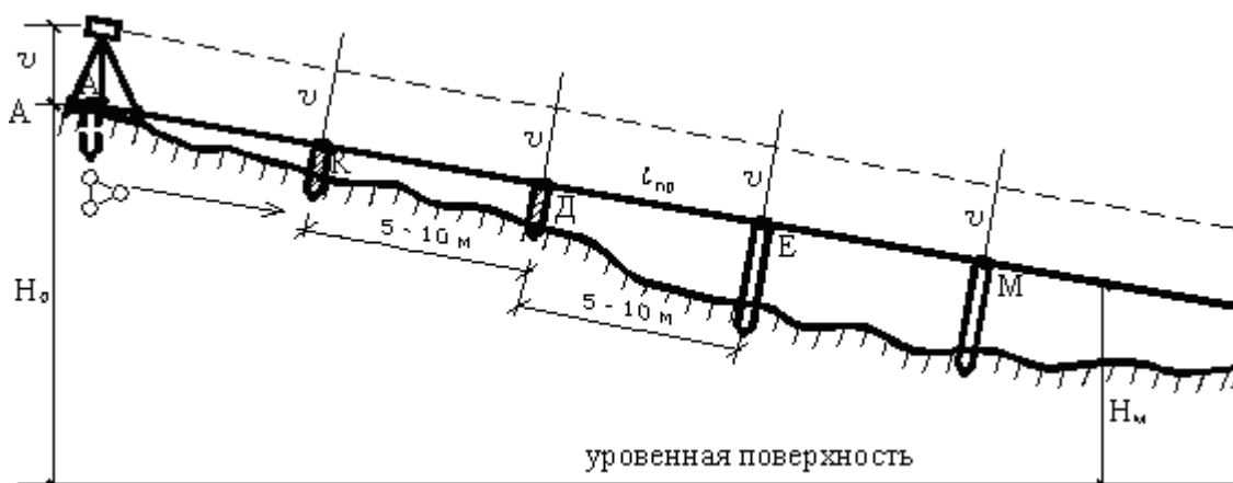
Рисунок 28 – Схема выноса линии с заданным проектным уклоном
