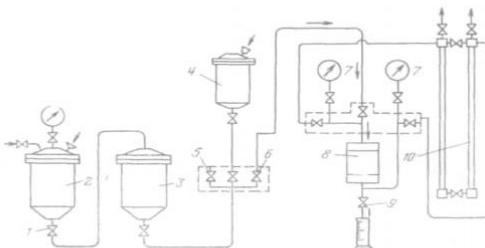
Рисунок 3 – Схема прибора для определения водопроницаемости горных пород
